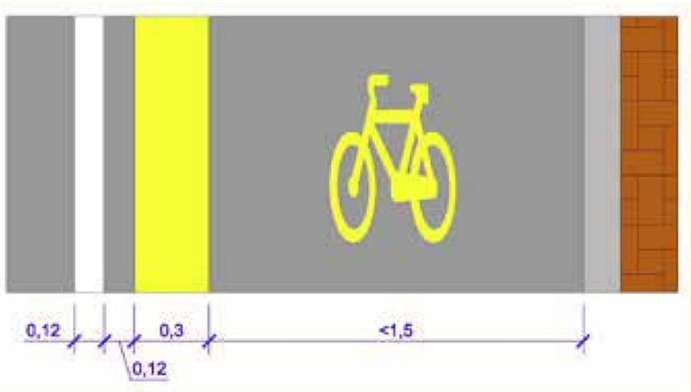
Fig. 2 - Segnaletica orizzontale con indicazione pista ciclabile
